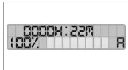
Soll der Boden nur nass gereinigt aber nicht getrocknet werden, einfach die Taste (08) auf der Bedientafel drücken und der Saugmotor schaltet sich nach etwa 15 Sekunden ab. Am Display der Bedientafel verschwindet das Symbol "A" und das Symbol "O" erscheint.
