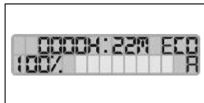
Falls im "ECO"-Modus nur der Reinigungszyklus ohne Trocknen ausgeführt werden soll, drücken Sie einfach die Taste (08) auf der Bedientafel und der Saugmotor schaltet sich nach etwa 15 Sekunden Nachlaufzeit ab. Am Display der Bedientafel verschwindet das Symbol "A" und das Symbol "O" erscheint. Nach Beendigung des Reinigungszyklus die Taste (08) drücken, damit die Maschine wieder reinigt und trocknet.
