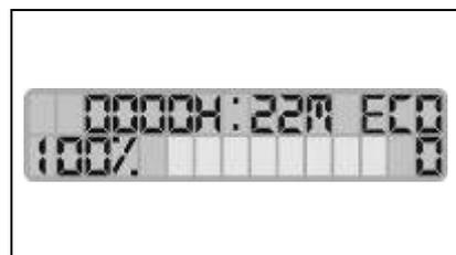
Falls im "ECO"-Modus nur der Reinigungszyklus, ohne Austritt von Reinigungslösung, ausgeführt werden soll, halten Sie ein paar Sekunden lang die Taste (09) an der Bedientafel gedrückt, auf diese Weise schaltet sich das Magnetventil ab und die Abgabe der Reinigungslösung wird deaktiviert.
